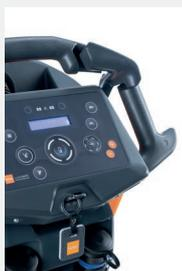
La technologie IntelliKey garantit sécurité et efficacité. Les utilisateurs autorisés peuvent se connecter et avoir accès aux réglages de la machine (débit d'eau et de solution, pression de brosse...). Cette nouvelle clé numérique fait office de coupe circuit lorsqu'elle est retirée.
